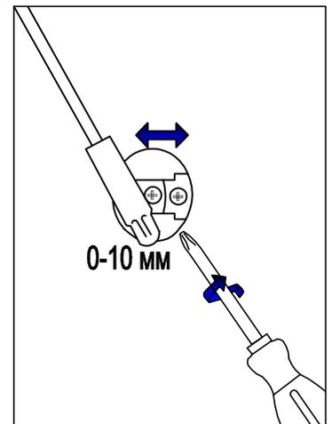
Открытие и закрывание двери может быть отрегулировано позицией лифта в креплении к боковине:
